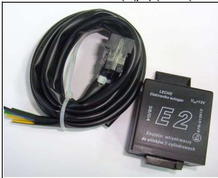
Widok sterownika z wiązką przyłączeniową
