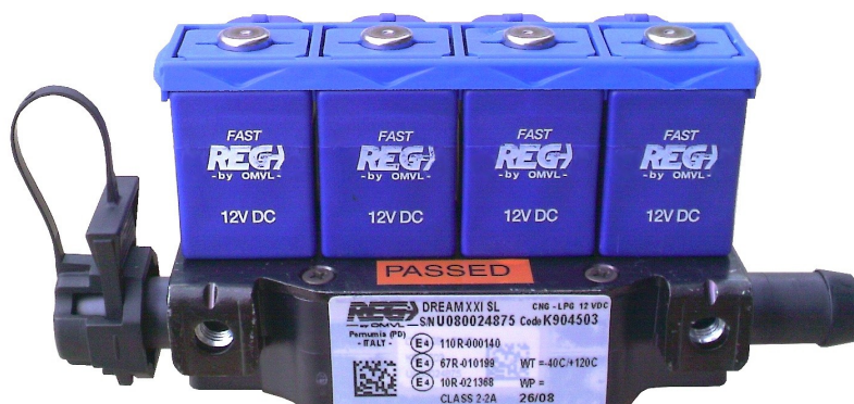
Rys. 3 Listwa wtryskiwaczy
