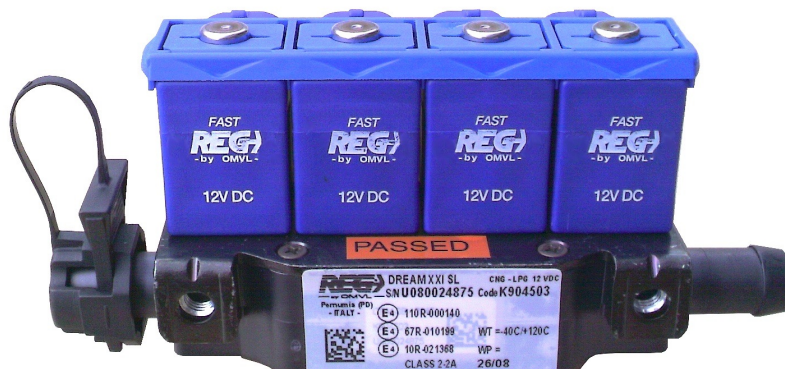
Rys. 3 Listwa wtryskiwaczy
