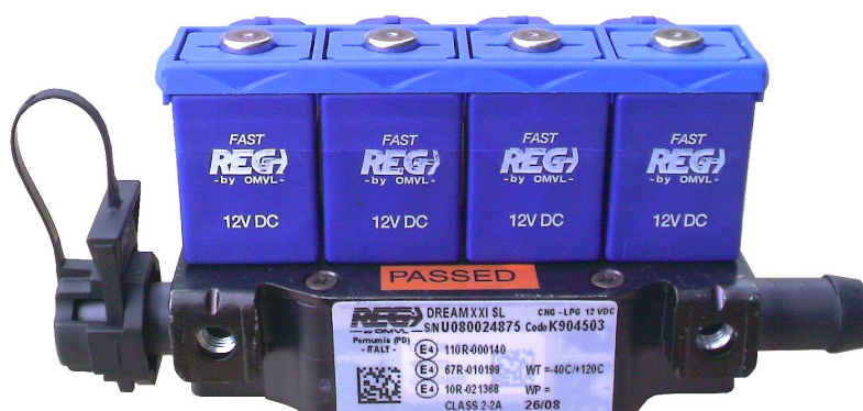
Rys. 3 Listwa wtryskiwaczy
